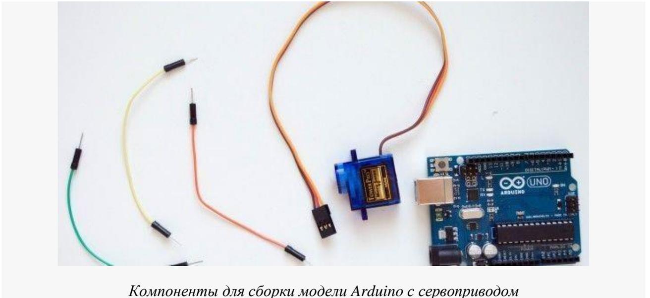
*Компоненты для сборки модели Arduino с сервоприводом*
